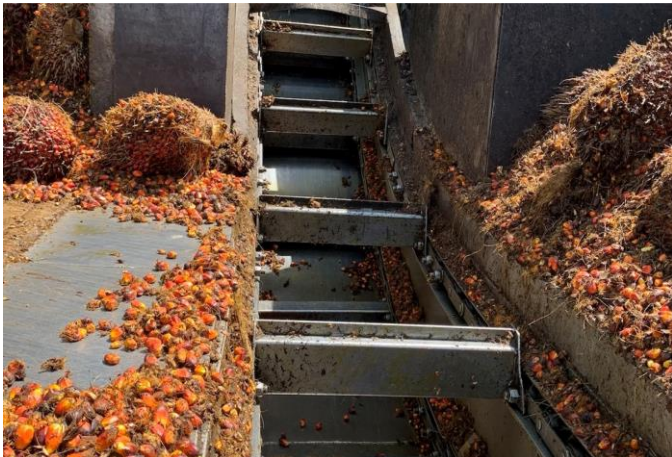
Transportadores de fruta cruda y esterilizada
