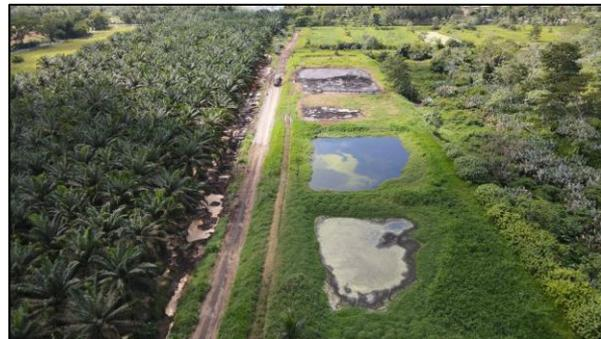
La descomposición del aceite de POME en las lagunas de aguas residuales genera emisiones de gases de efecto invernadero y puede contaminar las aguas subterráneas, con un impacto negativo en el medio ambiente.
